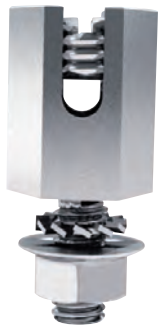
SFP4RE6 A boulon pour perçage ø 6 mm (0,26"). La rondelle éventail assure le contact électrique.
