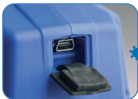
Électronique intégrée permettant un contrôle des paramètres de fonctionnement avec voyants et interface USB
